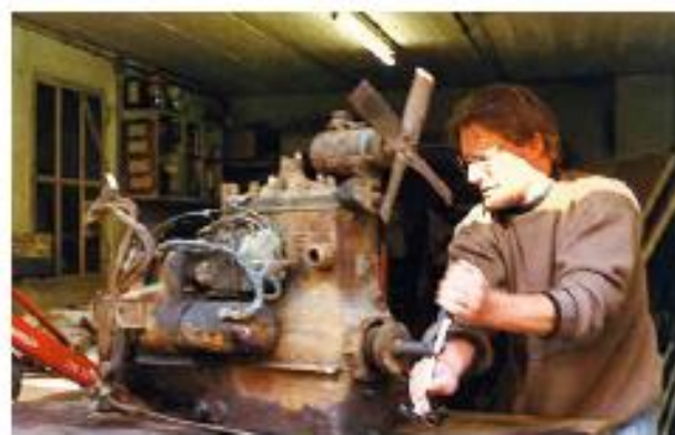
Démontage d'un moteur Mathis MY en vue d'une restauration, c'était en 1995.
