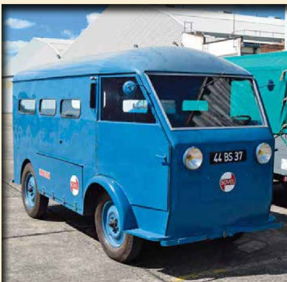
Sobre restauration pour ce rare petit utilitaire de marque Sovel à traction électrique bien dans l'air du temps. Datant de 1942, celui-ci était construit sur la base de la camionnette Chenard et Walcker.
