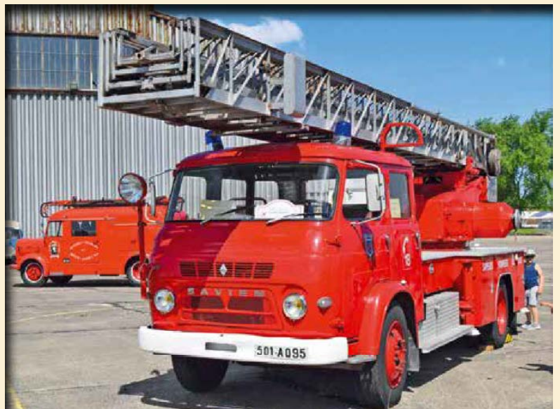
Grand classique du matériel d'incendie français des années soixante, un Savier S7 avec EPA (échelle pivotante automatique) 30 m Metz de 1965.
