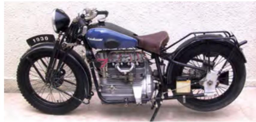
Sommet de la production Motobécane, la B7, une 750 à quatre cylindre et arbre à cames en tête, est présentée en 1930. Seule une poignée d'exemplaires a été fabriquée.
