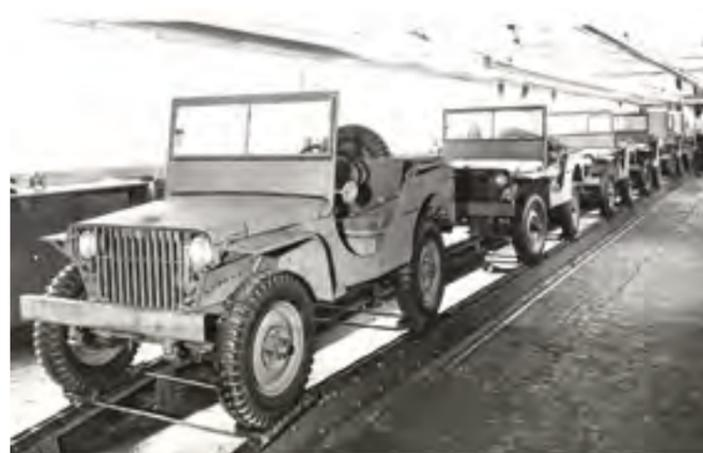
Ford montre tout son potentiel industriel avec la mise en production de sa GP, mais celle-ci est équipée d'un moteur de tracteur agricole pas assez puissant.
