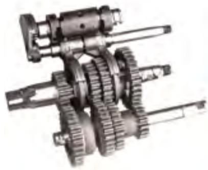
La boîte à quatre rapports de la série S. Parfaitement étagé, ce mécanisme supporte mal un usage brutal et reste le « talon d'Achille » de la Motobécane Superculasse.
