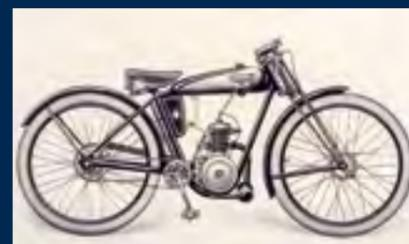
Ce T1V2 de 1932 est l'exemple même du minimalisme chez Motobécane. 100 cm<sup>3</sup>, 30 kg, 30 km/h, ni permis ni assurance !
