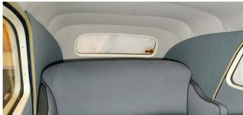
Réfection totale comme à l'époque pour le ciel de toit, les garnitures des portières, les sièges avant et la banquette arrière de cette Traction Citroën 11 Normale. Démontage, rénovation et remontage !
