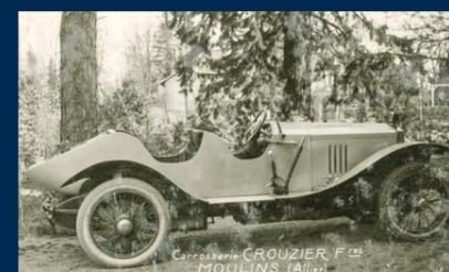
Bignan carrossée en skiff à quatre places avec roue de secours intégrée dans la pointe arrière et leviers de vitesse et de frein à main sur le marchepied.
