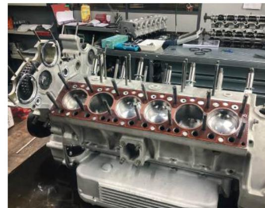
résidus colmatés depuis plusieurs décennies. Cette étape lui permet d'effectuer un premier contrôle visuel des pièces et de comprendre l'architecture du moteur. Il utilise ensuite des outils de métrologie pour contrôler les niveaux d'usure et de déformation de toutes les pièces internes du moteur, afin de mettre en place un plan de travail et déterminer quels éléments méritent d'être réparés, réglés, remis à neuf ou encore remplacés dans le moteur.
